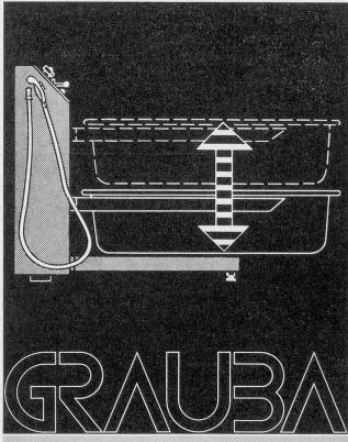
Arbeitshöhe verstellbar; mit Dusche- und Desinfektionsausrüstung
