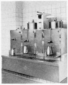
Neu ist bei HGZ die Grosscontainer-Brühstation, mit welcher der Kaffee direkt in 2 x 40 oder 2 x 70 Liter Containerwagen gebrüht werden kann. Die Containerwagen können mit automatischen Zapfstellen für die dosierte Portionierung, zum Beispiel bei Speiseverteileranlagen, ausgerüstet werden.
