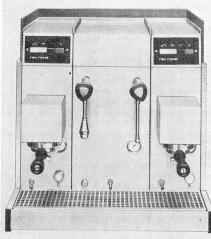
Eine Drucksteigerungspumpe gewährleistet den richtigen Arbeitsdruck und das Wasserdosiergefäss mit Elektroden ermöglicht das genaue Fixieren der Tassenmenge. Je nach Tasssengrösse wird eine Stundenleistung von 120 bis 180 Kaffee pro Gruppe erreicht. Ein temperaturregulierter Durchlauferhitzer sorgt für eine gleichmässig feine und aromatische Expresskaffe-Qualität mit der kompakten Schaumkrone.
