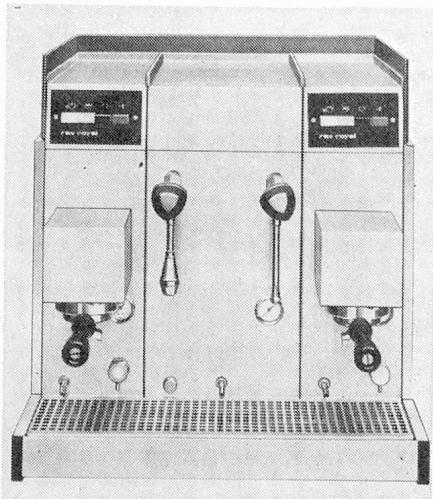
Eine **Drucksteigerungspumpe** gewährleistet den richtigen Arbeitsdruck und das **Wasserdosiergefäß mit Elektroden** ermöglicht das genaue Fixieren der Tassenmenge. Je nach Tassengrösse wird eine Stundenleistung von 120 bis 180 Kaffee pro Gruppe erreicht. Ein **temperaturregulierter Durchlauferhitzer** sorgt für eine gleichmässig feine und aromatische Expresskaffee-Qualität mit der kompakten Schaumkrone.
