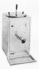
Wesentliche Merkmale des neuesten WAP-Modells: Moderne, zeitgemässe Form Gehäuse und Innenbehälter aus rostfreiem CN-Stahl Neuester Tomlinson-Hahnen Thermostat stufenlos einstellbar bis 84 ° mit eingebautem Schütz Überhitzungssicherung falls Schütz oder Thermostat ausfallen sollte Modelle für 5, 10 und 20 Liter Die WAP-Milchsieder sind mit einer Spezialheizung und stufenloser Schaltung
