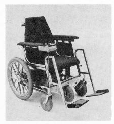
Der sensible Steuerknüppel ermöglicht sehr präzises Fahren in bezug auf die Richtung und Geschwindigkeit. Durch Umklappen der Steuereinheit wird das dichte Anfahren an Tische ermöglicht. Von der Konstruktion her gewährleistet vor allem das neu entwickelte Planetengetriebe mit absoluter Selbsthemmung die beruhigende Sicherheit. Bremsen werden dadurch überflüssig.
