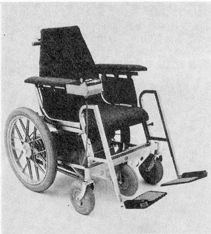
Der sensible Steuernüppel ermöglicht sehr präzises Fahren in bezug auf die Richtung und Geschwindigkeit. Durch Umklappen der Steuereinheit wird das dichte Anfahren an Tische ermöglicht. Von der Konstruktion her gewährleistet vor allem das neu entwickelte Planetengetriebe mit absoluter Selbsthemmung die beruhigende Sicherheit. Bremsen werden dadurch überflüssig.
