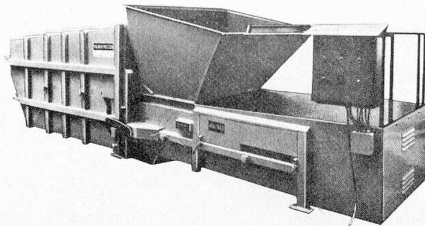
Pressen für Absetz- oder Gleitabsetzkipper. Beschickung manuell, über Transportbänder und Abfallschächte oder mit Container-Kippvorrichtung. Hohe Verdichtung: bis auf ein Zehntel des bisherigen Volumens.
