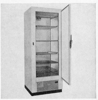
Gastro-Norm-Kühlschrank mit 650 l Inhalt. Zwangsluftgekühlt. Ausführungen in Stahlblech weiss einbrennemailliert oder in Chromnickelstahl. Isolation in Polyurethan geschäumt. Anlage steckfertig mit gekapseltem Kühlaggregat. Automatische Tauwasserverdunstung.
