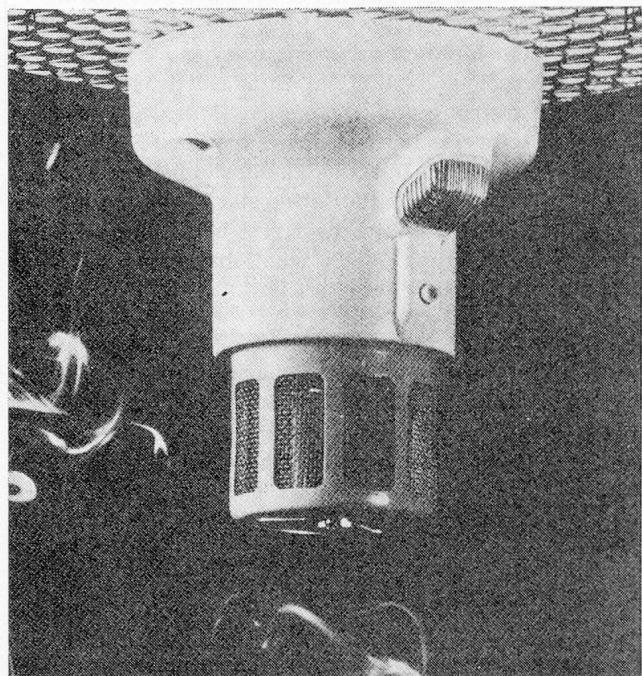
Die Brandnase ist das Fundament des modernen elektronischen Brandschutzes, der automatischen Früherkennung von Bränden. Sie besitzt eine geschlossene und eine offene Kammer mit ionisierter Luft, die damit elektrisch leitfähig wird. Beim Eindringen von Rauch und anderen Brandprodukten in die offene Kammer erhöht sich der Widerstand gegenüber der geschlossenen Kammer. Dieser Effekt wird ausgenutzt, um den Alarm auszulösen.
