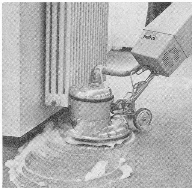
Mit der Servo-Wetrok-Einbürsten-Bodenreinigungsmaschine mit 43 cm Ø, ausgerüstet mit dem Shampomat Schaumaggregat, kann 100 %ig randnah und auch unter Radiatoren und Möbeln einwandfrei gereinigt werden. Lästige Handarbeit entfällt.
