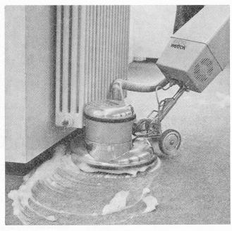
Mit der Servo-Wetrok-Einbürsten-Bodenreinigungsmaschine mit 43 cm  $\phi$ , ausgerüstet mit dem Shampomat Schaumaggregat, kann 100 % ig randnah und auch unter Radiatoren und Möbeln einwandfrei gereinigt werden. Lästige Handarbeit entfällt.
