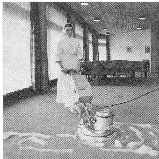
Beim Shampooieren in einem Alters- und Pflegeheim. Mit einer Einbürsten-Bodenreinigungsmaschine, ausgerüstet mit Shampooebürste und dem Shampooat — einem Schaumaggregat mit elektronisch gesteuerter Shampoofeuchtigkeit zwecks Anpassung an Verschmutzung und Teppich. Bei Verwendung des Wetrok-Shampoo Optimal wird so in einem Arbeitsgang gereinigt und gleichzeitig desinfiziert.
