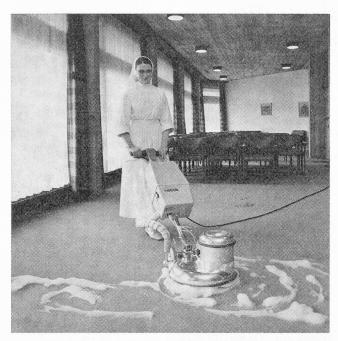
Beim Shampoonieren in einem Alters- und Pflegeheim. Mit einer Einbürsten-Bodenreinigungsmaschine, ausgerüstet mit Shampoonierbürste und dem Shampomat — einem Schaumaggregat mit elektronisch gesteuerter Shampoofeuchtigkeit zwecks Anpassung an Verschmutzung und Teppich. Bei Verwendung des Wetrok-Shampoo Opital wird so in einem Arbeitsgang gereinigt und gleichzeitig desinfiziert.
