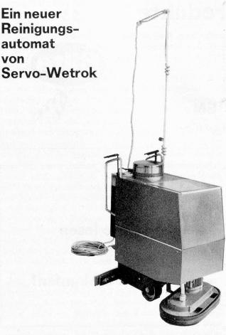
Mit der Duomatic 50 E hat die Servo-Wetrok-Organisation einen neuen Reinigungsautomaten entwickelt. Eine kleine Variante ihrer Triomatic-Maschinen. Die neue Konstruktion ist besonders handlich und wendig. Die ideale Maschine für jene Betriebe, wo bisherige Reinigungsautomaten entweder zu gross oder zu schwer waren.
