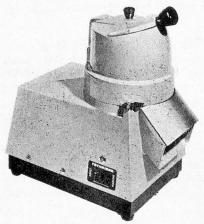
Gehäuse und Aufsatz aus emailliertem Aluminiumguss und rostfreiem Stahl. Reibscheiben 180 mm ( rostfrei. Sofortige Verriegelung und Lösen der Schneidscheiben mittels Bajonnetverschluss. Einfachste Handhabung. Motor 1 x 220 V oder 3 x 380 V, 2/3 PS Höhe total 43 cm 38 cm Breite Tiefe 23 cm Gewicht 20 kg 1 Jahr Garantie Preis des kpl. Gerätes (ohne Schneid-
