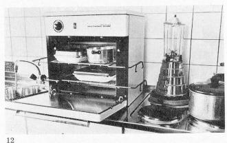
In der Küche steht der kleinste Régéthermic-Apparat «2T». Die beiden Teller und die Suppe werden in den Apparat eingeschoben und thermisch regeneriert (Bilder 11 und 12).
