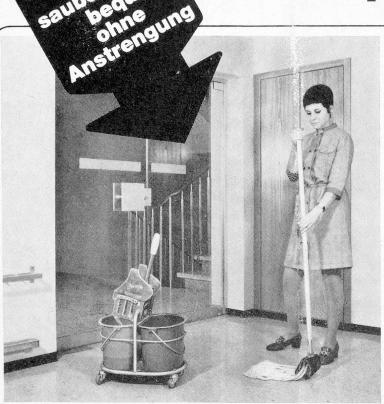
Die TASKI DUO-Mopausrüstung besteht aus nur einem Fahrgestell mit 2 sehr leichten Eimern (ermöglichen fast geräuschloses Arbeiten), Mop und Presse.
