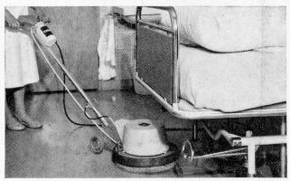
TASKI S—die erste geräuscharme Reinigungsmaschine mit eingebautem Spraygerät. Niedrige Bauart — leicht verstellbarer Stiel — erleichtert das Arbeiten unter Betten und Tischen.
