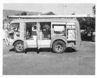
Pikettwagen mit Kleinlöschgeräten, Handfeuerlöschern, Schlauchmaterial, Pressluft- und Gasschutzgeräten, Leitern usw.
