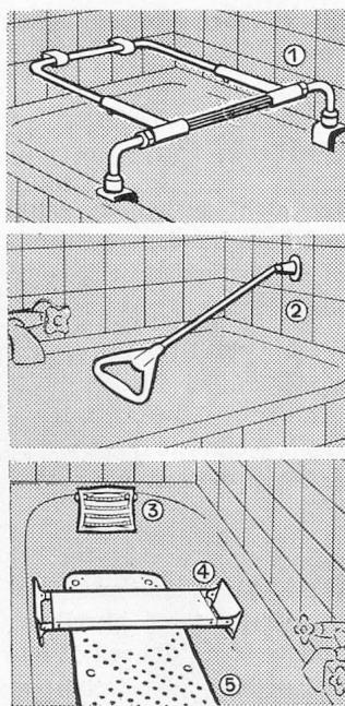
① **Bade-Helfer**, wird am Wannenrand oder an der Wand montiert. Sichere Stütze beim Einstiegen oder Verlassen der Badewanne aus eigener Kraft.
