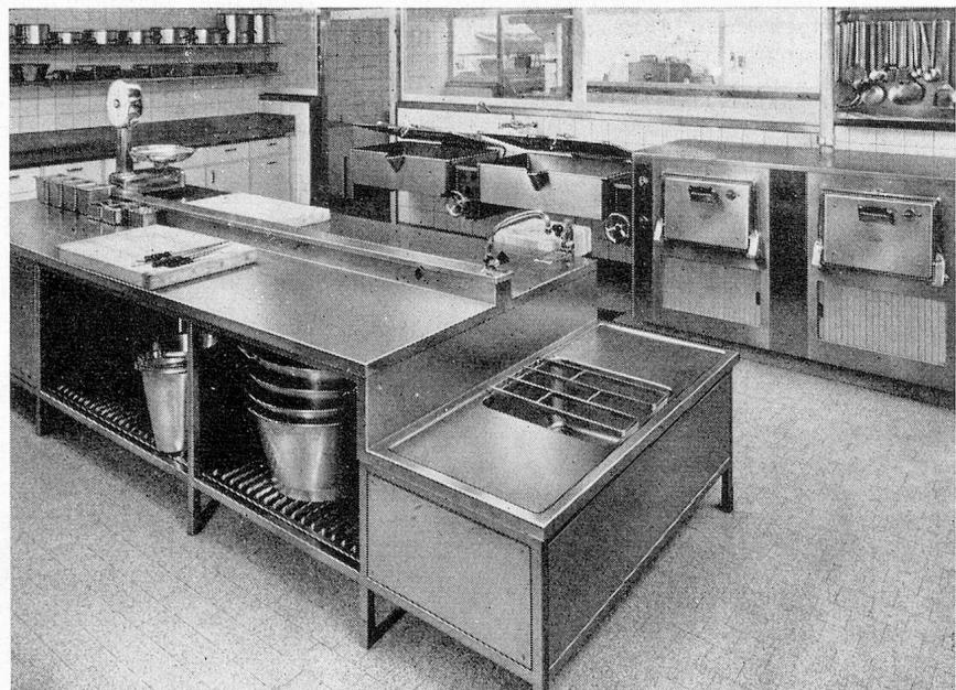
Komplette **Grosskücheneinrichtungen** umfassend: Elektrische Grossküchenapparate sowie Chromnickelstahl-Ausrüstungen, wie Plongen, Arbeitstische, Schubladenstöcke, Geschirr- und Gemüsewaschanlagen inkl. die erforderlichen Küchenmaschinen.
