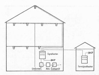
Schematische Darstellung der Anordnung einer automatischen Feuermeldeanlage.
