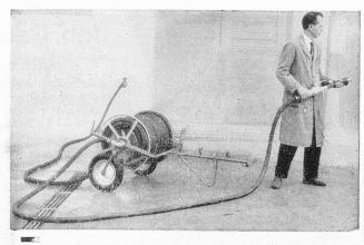
Fahrhaspel mit Speisung des Mehrzweckrohres durch die sich drehende Haspelachse.
