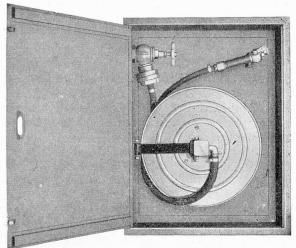
Modell VGA-60 SchUP. Unterputzschrank mit Wasserzufuhr durch die Haspelachse. Zch.-Nr. 2529
