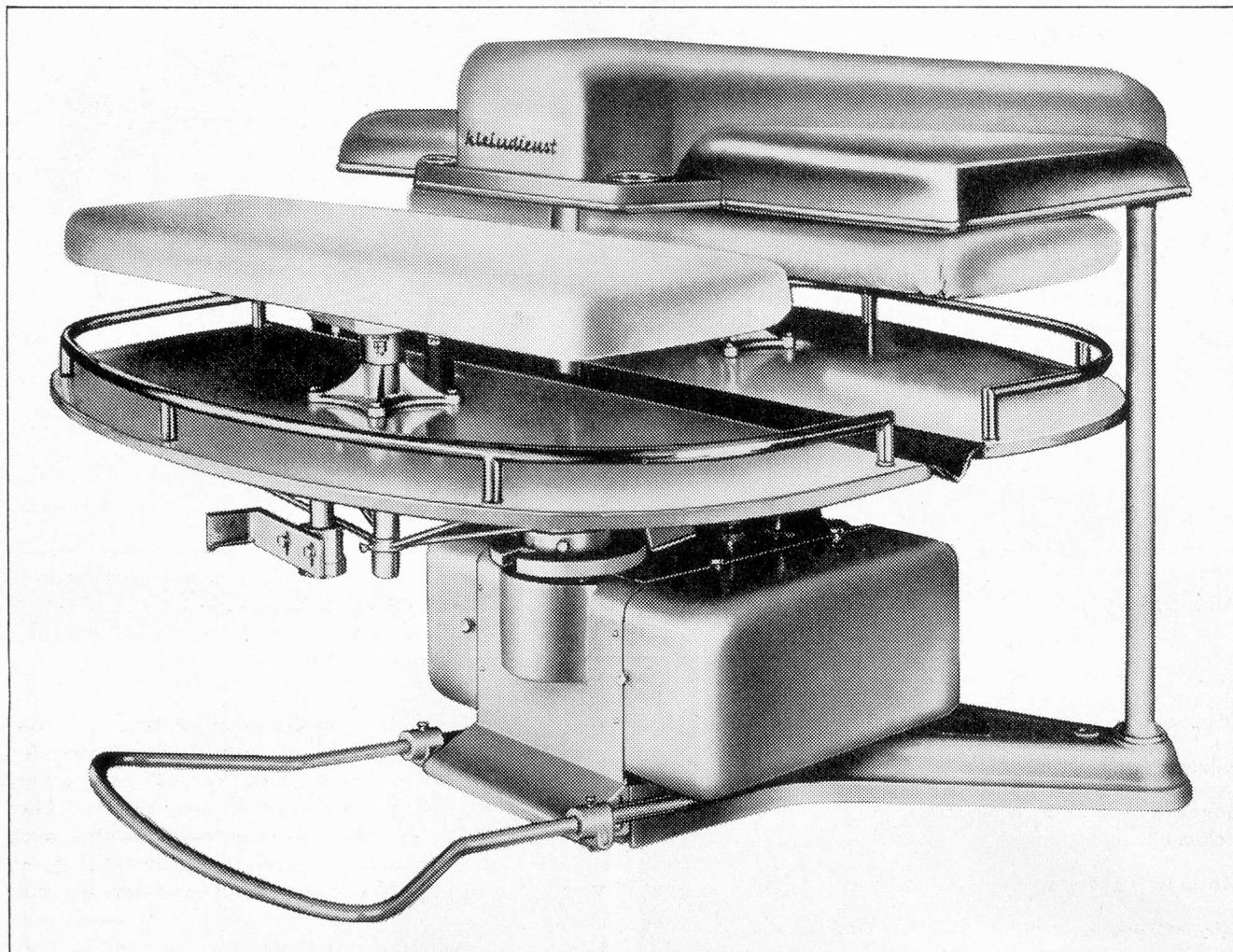
Fabrikationsprogramm: Einfache Pressen, Kärrussellpressen, Spezialpressen für Berufskleider, komplette Pressesätze für Berufskleider, Hemden etc. Schon in kleineren Anstalten und Spitälern, von 80 Betten an, können Kleindienst-Pressen rationell eingesetzt werden.
