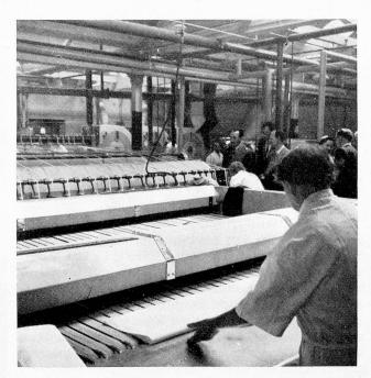
Die Leintücher kommen aus der Mange in den Faltapparat und verlassen die Maschinen zweimal längsgefaltet.
