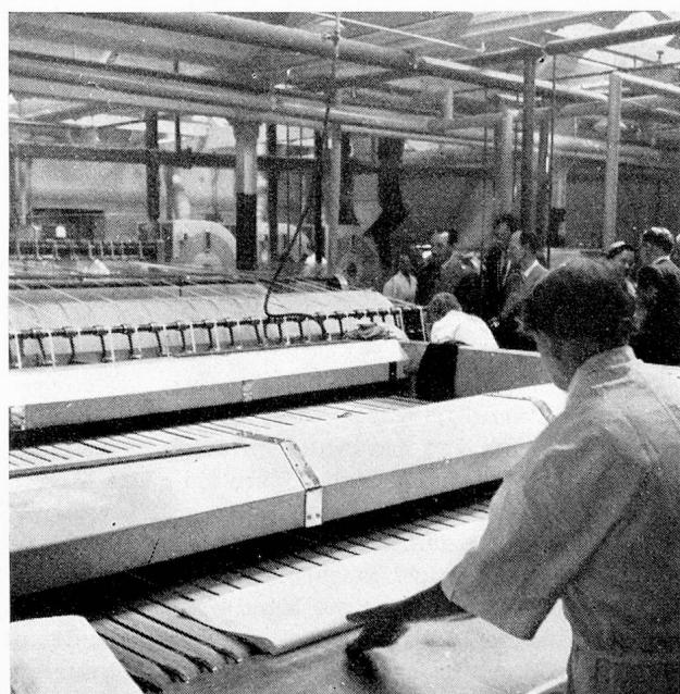
Die Leintücher kommen aus der Mange in den Faltapparatur und verlassen die Maschinen zweimal längsgefaltet.
