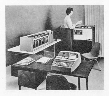
werden: wegen der konsequenten Verwendung modernster Bauteile (Transistoren usw.) und vor allem, weil die IBM hier erstmals eine Kleinlochkarte von der halben Grösse der üblichen Karten verwendet, wobei aber auch auf dieser Kleinlochkarte die volle normale Kapazität von 80 Kolonnen zur Verfügung steht.
