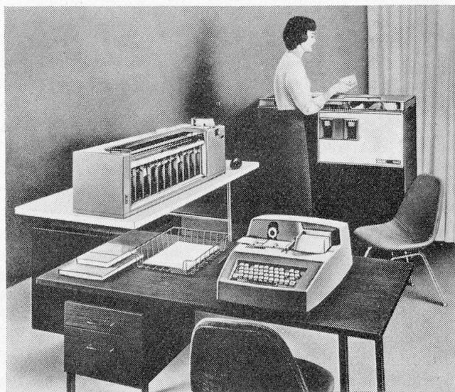
werden: wegen der konsequenteren Verwendung modernster Bauteile (Transistoren usw.) und vor allem, weil die IBM hier erstmals eine Kleinlochkarte von der halben Grösse der üblichen Karten verwendet, wobei aber auch auf dieser Kleinlochkarte die volle normale Kapazität von 80 Kolonnen zur Verfügung steht.
