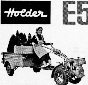
mit 5-PS-Fichtel- und Sachs-Motor, 7-Gang-Getriebe. Verwendbar als Fräse,
