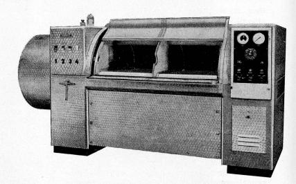
Immer mehr Spitäler und Anstalten arbeiten mit vollautomatischen Klarstrom-Waschmaschinen Grössen von 10-150 kg Fassung und Leistung pro Std.
