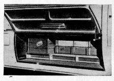
Sicher abschliessbares, staub- und regengeschütztes Warenfach von rund 2 m² Fläche... ideal für empfindliches und wertvolles Ladegut (bestgefedert zwischen den Achsen transportiert)
