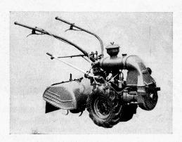
baugeräten, die vor der Maschine arbeiten (Rasenmäher, Schneeschaufel, Strassenbürste), notwendig ist. Auch besitzt die Maschine einen Rückwärtsgang, welcher bei Zugarbeiten und beim Fräsen von kleinen Parzellen oder in Gärten mit Bäumen und Hecken ein grosser Vorteil ist.
