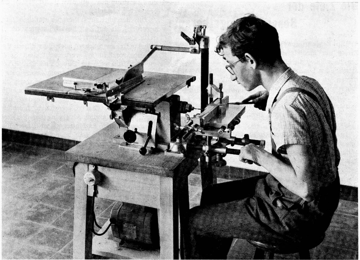
In der Anlernwerkstätte Untermoos, Zürich. Der Zögling führt eine serienmässige Bohrarbeit an einem Holzteil für Ruderbootsitze aus. (Klischee: Kant. Jugendamt Zürich.)
