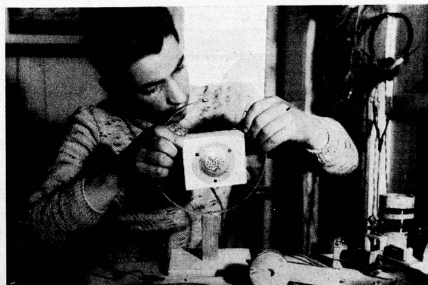
Das selbstgebaute Mikrophon wird mit Hilfe von Federn in den ebenfalls selbstgebauten Ständer gehängt
