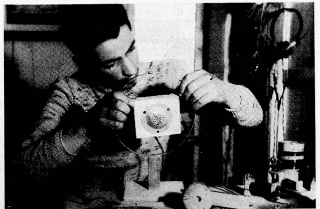
Das selbstgebaute Mikrophon wird mit Hilfe von Federn in den ebenfalls selbstgebauten Ständer gehängt
