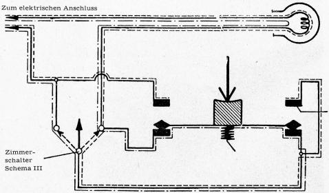
Strom in der Nacht; beim Läuten (Knopf eingedrückt): Der Strom wird unterbrochen, die Lampen löschen aus.
