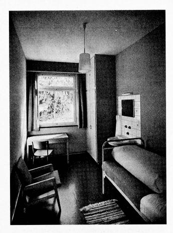
Patientenzimmer mit Fenster ohne Griff. Die Lüftung erfolgt durch Klimaanlage. Rechts Waschbecken mit runden Drehknöpfen als Hahnen. Photo Wolgensinger
