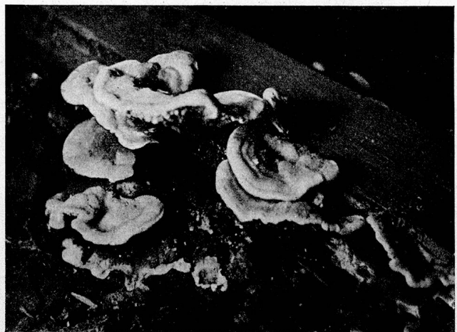
Zerstörung eines Bodenbalkens durch den echten Hausschwamm
