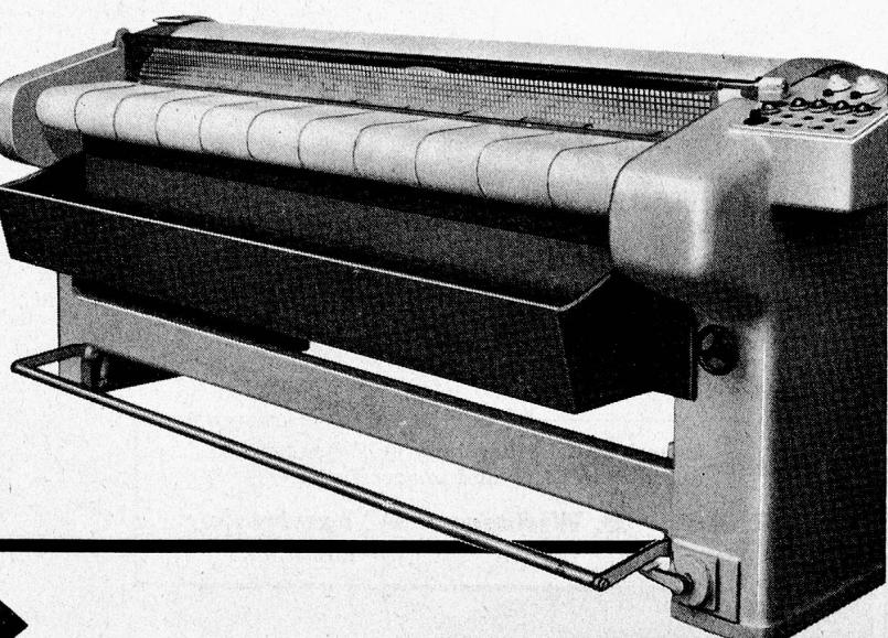
18 verschiedene Typen von Glättemaschinen bauen wir. Als Beispiel zeigen wir Ihnen hier unsere neueste Mulden-Glättemaschine Brillant in vollständig geschlossener Bauart mit automatischer Heizanlage.
