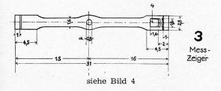
Die beiden Messzeiger aus dem 1,5 bis 2 mm dicken Sperrholz sind ebenfalls genau zu arbeiten. Zuerst die Längsachse mit sehr hartem und spitzem Bleistift genau gerade anreissen. Das Loch für die Achse in der Mitte ist so zu machen, dass die Mittellinie ganz genau durch die Lochmitte verläuft. Der Durchmesser des Loches richtet sich nach der Bohrung der Grammo-
