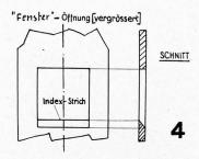
Das «Fenster» auf der einen Zeigerseite erlaubt, den eingestellten Winkel auf der Messcheibe abzulesen. Diese Aussparung zu machen ist einfach. Zuletzt wird an der äusseren Kante eine schräge Fläche angefeilt. Nun kommt das wichtigste: Ganz genau mit der Längsachse übereinstimmend wird der Index-Strich mit dem harten spitzen Bleistift eingezeichnet. Die Zeichnung zeigt dies alles vergrössert. Der Index-Strich zeigt die Gradeinstellung genau an.
