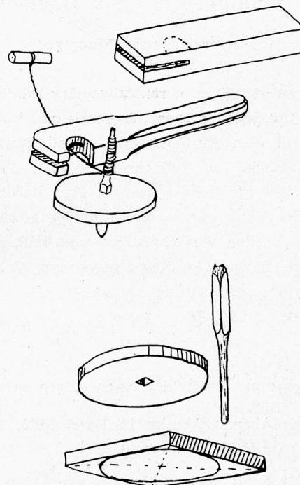
die runde Scheibe wird ein Brettchen von 1 cm Dicke verwendet. Genau in seiner Mitte wird ein quadra-
