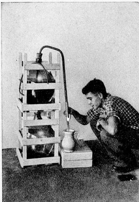
Ausschank mit Siphon (Leistung 12 Liter pro Minute)
