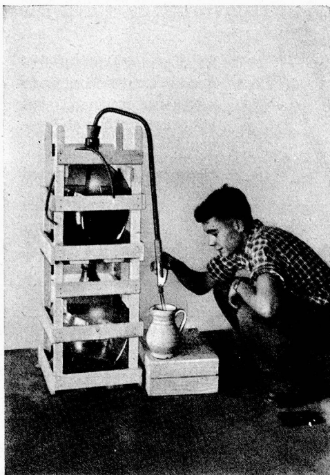
Ausschank mit Siphon (Leistung 12 Liter pro Minute)
