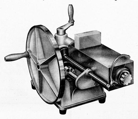
Mit der **neuen** Butterportionsmaschine **VARIA** haben Sie die Möglichkeit, Butterscheibchen von beliebigem Gewicht herzustellen, wie es Ihr Betrieb gerade erfordert, zum Beispiel 10, 13, 17<sup>1</sup>/<sub>2</sub>, 20, 23 Gramm usw. Die Portionengrösse kann im Bereiche von 10 bis 30 Gramm **stufenlos** eingestellt werden.
