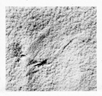
Abb. 4 Mechanischer Schaden an einem Barchentleichtuch
