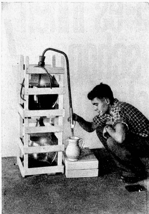
Ausschank mit Siphon (Leistung 12 Liter pro Minute)
