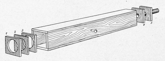
Abb. 2 Die Holzteile für das Kasten-Fernrohr.
