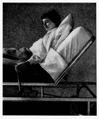
die bei Bedienung eines der auf beiden Bettseiten angebrachten Hebel (4), das Heben oder Senken des Kopfteils geräuschlos besorgt. Der genesende Patient kann diese Manipulation selbst vornehmen, ohne die Krankenschwester bemühen zu müssen; die Hebel können aber auch so gestellt werden, dass der Kranke sie nicht bedienen kann. Da heute in der Industrie besonders zuverlässige Funktionen in zunehmendem
