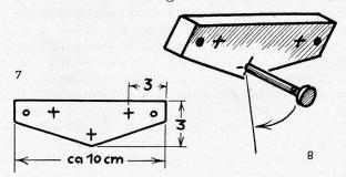
für das Zugseil zu durchbohren. Das Zugseil wird dort festgebunden. Bei den oberen angekreuzten Punkten werden die Radachsen eingeschraubt, beim unteren kommt der Nagel zu sitzen, der die «Kabine» trägt. Die Abbildungen 8 und 9 zeigen, wie der Nagel zu formen ist.
