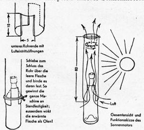
dem langen Papierrohr, ein aufsteigender Luftstrom, der zuoberst auf das Schaufelrad stösst und dieses dreht. Ueberlegt, wie ein kleineres und wie ein grösseres Rohr wirkt.
