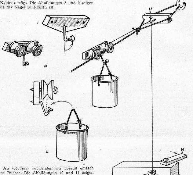
Als «Kabine» verwenden wir vorerst einfach eine Büchse. Die Abbildungen 10 und 11 zeigen die ganze Laufvorrichtung und dass die «Kabine» genau senkrecht unter die Mitte der Laufräder aufgehängt werden muss.
