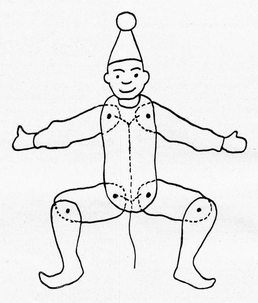
sauber mit der Laubsäge ausgesägt, bei Karton eventuell mit einer Schere ausgeschnitten. Dann versehen wir Arme, Oberschenkel und Unterschenkel mit Bohrlöchern, damit sie leicht beweglich auf den Körper geschraubt werden können. Arme und Oberschenkel erhalten zudem noch ein Loch, an dem der Bindfaden befestigt werden kann. Die punktierten Linien auf der
