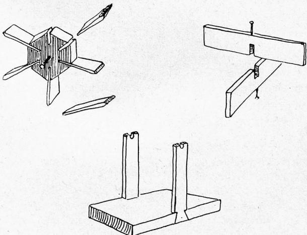
Rädchen sauber mit Glaspapier. Spalte aus einem Fichtenscheit 2 mm dicke, 6 cm lange und 2 bis 2,5 cm breite Schindelchen als Schaufeln. Schnitze sie auf der einen Seite so dünn zu, dass du sie in den Sägeschnitt hineintreiben kannst. Sie sollen fest sitzen. Zwei im Zentrum eingetriebene kleine Nägel
