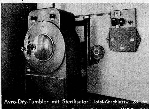
Avro-Dry-Tumbler mit Sterilisator Total-Anschlussw. 28 kW
