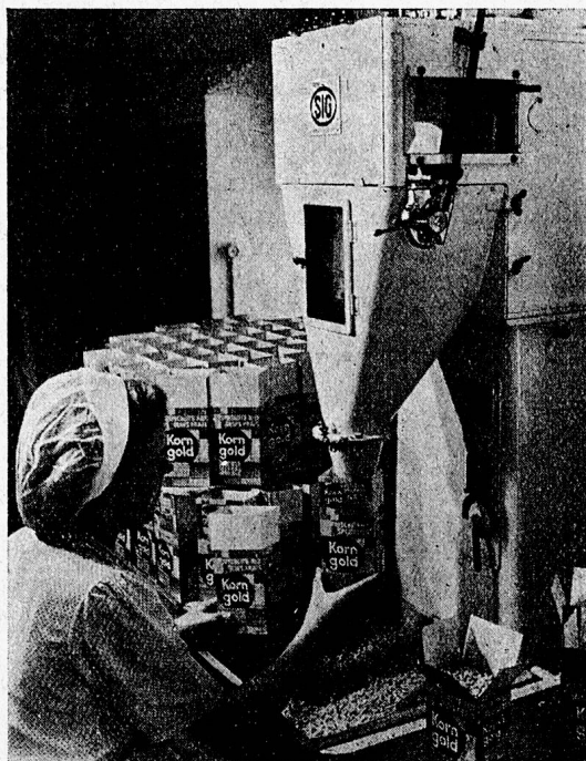
Eine Füllmaschine füllt automatisch die Pakete mit dem abgewogenen Quantum.
