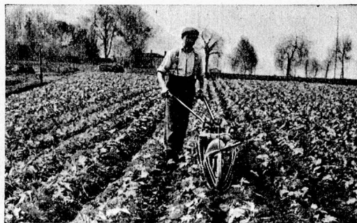
Hacken mit seitlicher Führung und Pflanzenschutzgitter in engen Reihenkulturen
