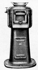
Kartoffel- und Rüben-Schälmaschinen für elektrischen Antrieb
