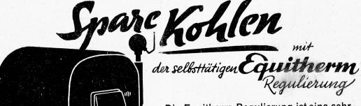
Die Equitherm-Regulierung ist eine sehr einfache Apparatur, welche die Kesseltemperatur ganz automatisch in Abhängigkeit von den Witterungsverhältnissen, mittelst einem Aussenfühler reguliert und dadurch bei geringstem Heizmittelverbrauch eine stets gleichbleibende Raumtemperatur garantiert.
